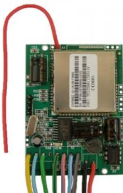
GSM сигналізація OKO-ECONOM призначена для віддаленого контролю, управління і оповіщення про стан об'єкта (квартири, дачі, гаража і т.д.) за допомогою мобільного телефону або комп'ютера, використовуючи мережу стільникового зв'язку.
