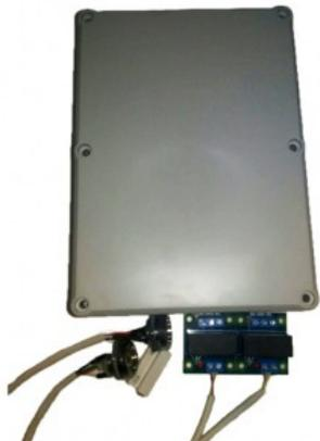
Автономный контроллер 4С4К, который используется в системах контроля и управления доступа. 4С4К контролирует 2 места прохода и может управлять электрозамками с помощью звонка или мобильного приложения, ключей формата ТМ и радиобрелков, с помощью приемопередатчика TRX-PRO. Всего можно привязать 6400 номеров, 6400 ключей и 6400 радиобрелков. Соединение с устройством не происходит, контроллер заканчивает вызов сразу, то есть деньги с абонента не снимаются.
