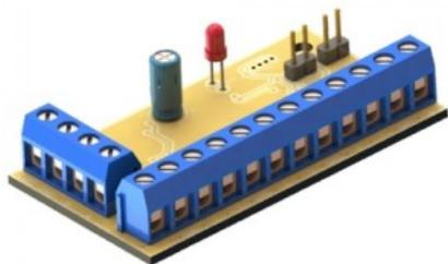
Плата расширения входов позволяет по цифровой шине RS-485 увеличить количество охранных зон до 8 шт. Максимально можно подключить 4 платы.
