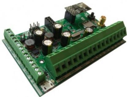
Многофункциональный GSM-контроллер «ОКО-ЕХw» применяется для дистанционного контроля и управления на стационарных объектах (офис, дом, квартира, дача, гараж, склад, киоск и т.д.), выполняя одновременно ряд функций:
