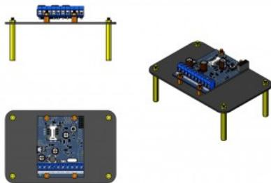
Комплект KIT-7S2-BOX30W предназначен для монтажа GSM-контроллеров ОКО-7S / S2 в корпусе блока бесперебойного питания FARADAY UPS-BOX 30 Simple
