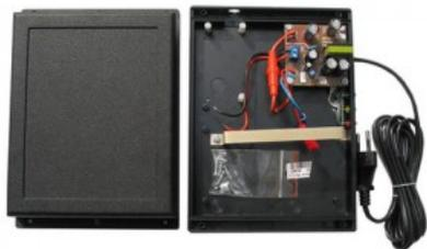
Корпус с бесперебойным источником питания, местом для установки ОКО-S, ОКО-U, ОКО-U2 и аккумулятора 1,2 АЧ
