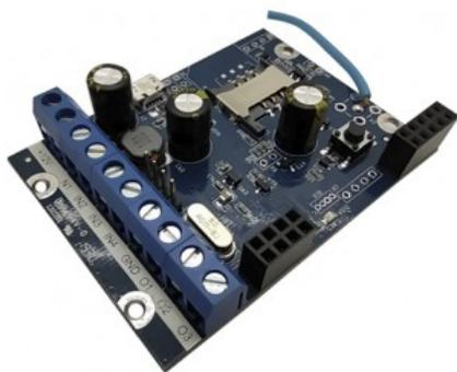
GSM-контроллер "OKO-7Sw" предназначен для удалённого контроля, управления и оповещения о состоянии стационарного объекта с помощью мобильного телефона или компьютера, используя сеть сотовой связи.
