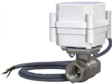
Шаровой электропривод предназначен для перекрытия водоснабжения (отопления) в случае возникновения протечки воды. Шаровой электропривод состоит из шарового крана и электропривода для управления шаровым краном.
