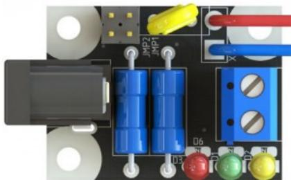
UPS-14 применяется для автоматического переключения питания устройства (при исчезновении входного питания) на резервный АКБ (например, в охранных системах, домофоны, системы связи и т.д.). UPS-14 используется вместе с блоком питания постоянного напряжения.
