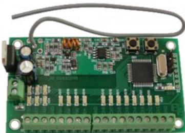
Данное устройство предназначено для приема сигналов от беспроводных датчиков и брелоков, выдачи сигналов тревоги, состояния и управления на приемно-контрольные устройства с логическими входами (без анализа сопротивления шлейфа). Работает также с датчиками фирмы Visonic.
